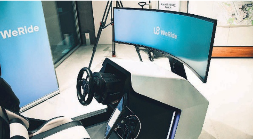
Aus dem Remote-Cockpit können die Shuttlebusse am Flughafen dereinst ferngesteuert werden.
