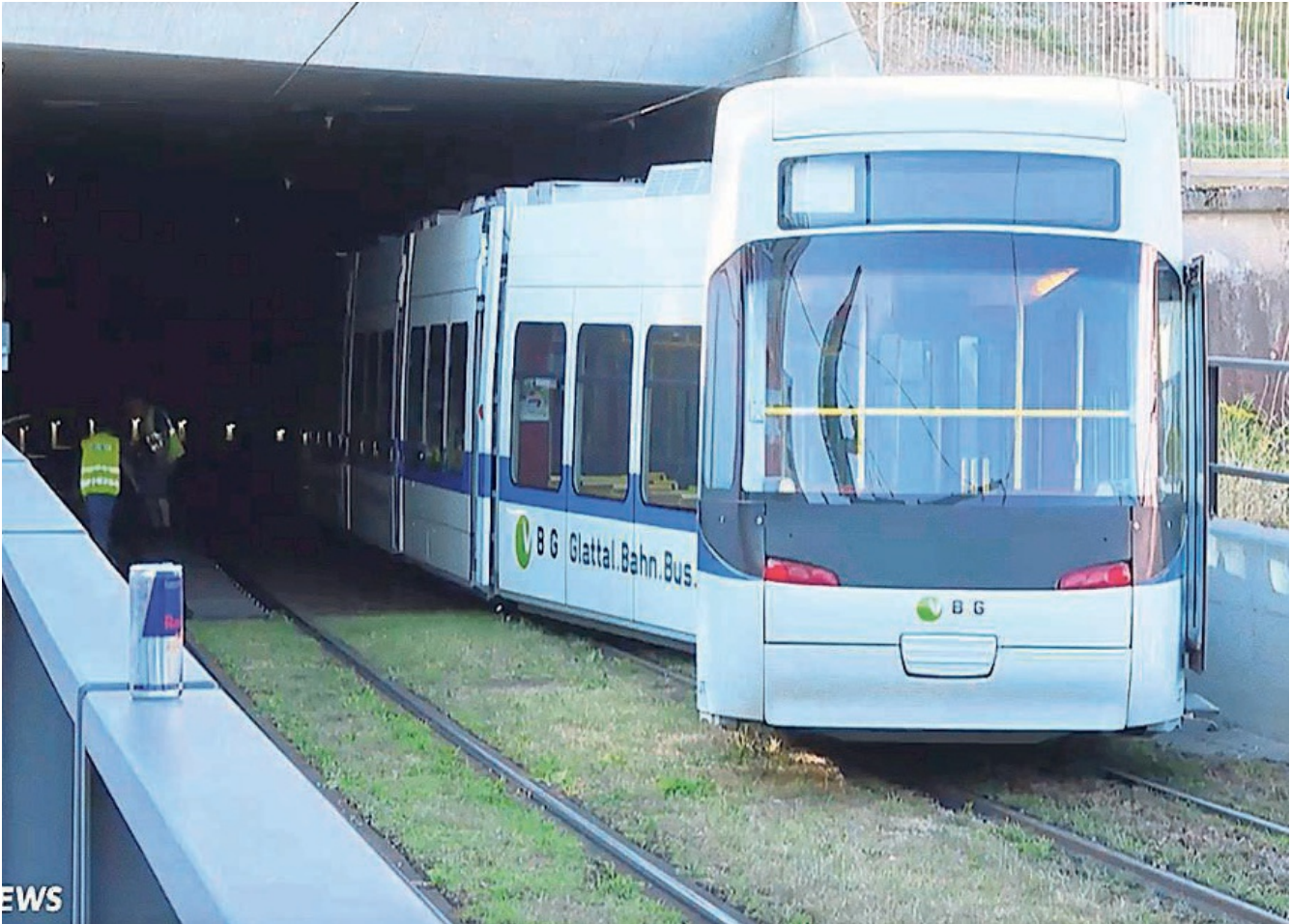
Das Tram kam kurz vor dem Margaretentunnel endgültig von den Schienen ab und beschädigte Teile der Sicherungsanlage.
