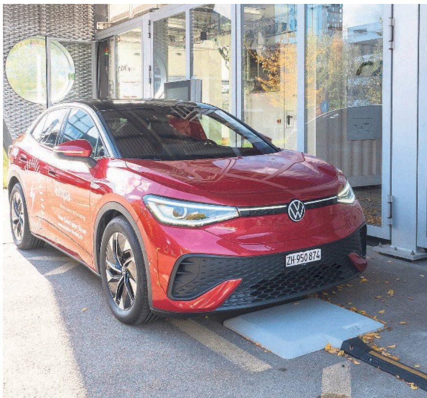
Ein umgerüstetes E-Auto lädt kabellos über die im Boden integrierte Spule – der Ladevorgang startet automatisch, sobald das Fahrzeug korrekt parkiert ist.
