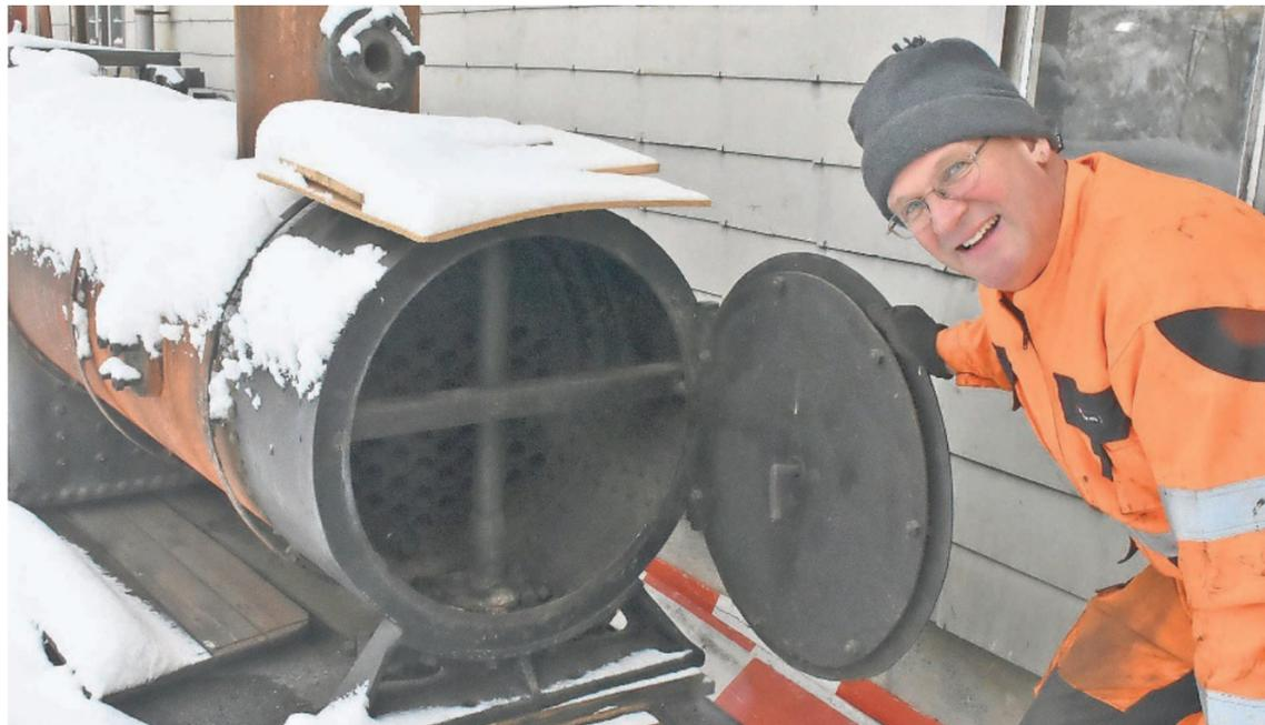
Daniel Rutschmann hat den Dampfkessel seiner Lok ausgebaut und für die Sanierung beim letzten Schweizer Kesselschmied bereitgestellt.
