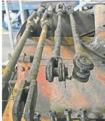
Alle Einzelteile werden demontiert und wieder in den Originalzustand gebracht.
